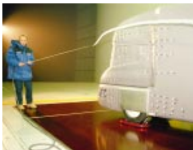
Nya aerodynamiska lösningar testas främst genom vindtunnelprov.
