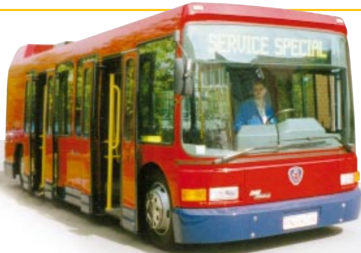
Scania utvecklar en hybridbuss med bränslecell som energikälla, byggd i Silkeborg i Danmark.
