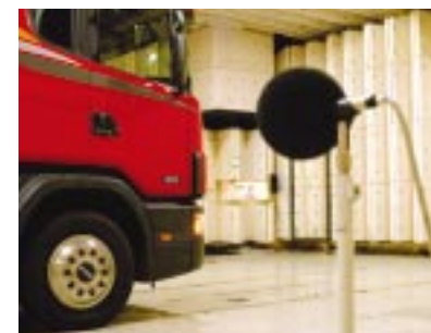
De yttre bullernivåerna mäts både genom laborietester och fältprov.
