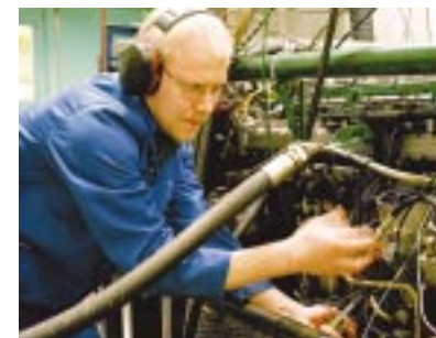
Motorens egenskaper långtidstestas i motorprovceller.
